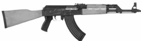
Jugoslavanska avtomatska puška M70, kaliber 7,62 mm.
