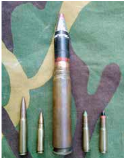
Kalibri nabojev (z leve): 7,9 mm; 7,62 mm; 20 mm; sledilni in zažigalni naboj 7,62 mm
